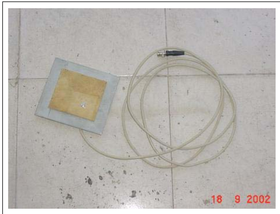
Gambar 5. Patch Antenna yang sudah selesai.
