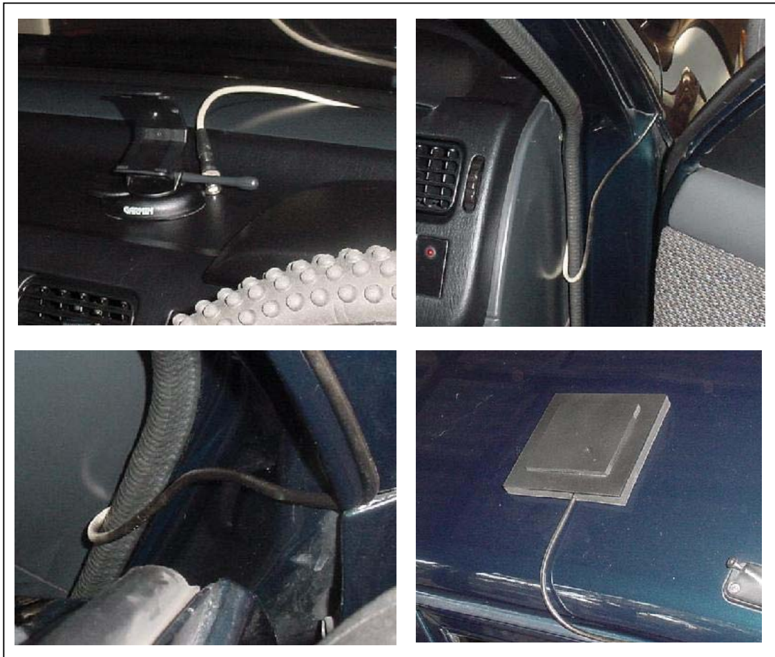
Gambar 7. Instalasi pada mobil.
